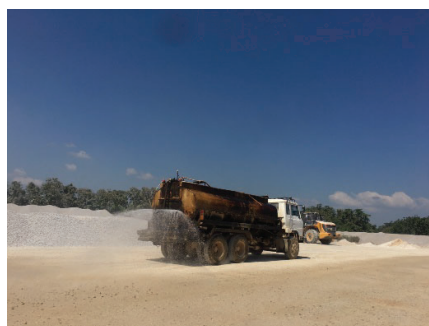
รูปที่ 2-16: การฉีดพรมน้ำบริเวณลานกองแร่
